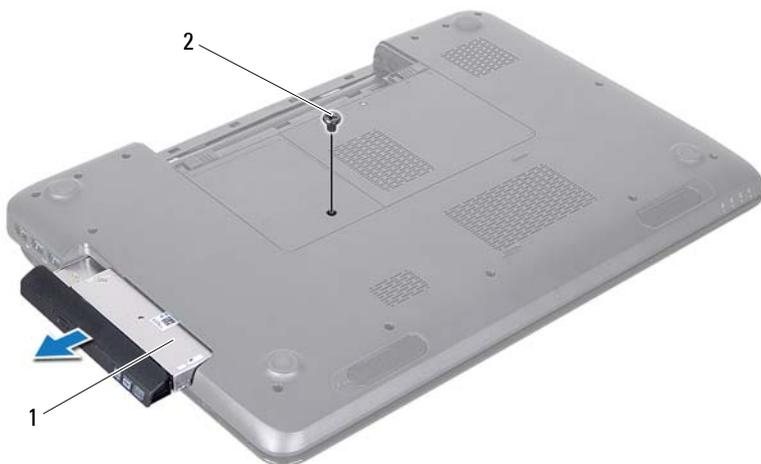
1 Sklop optičnega pogona      2 Vijak
